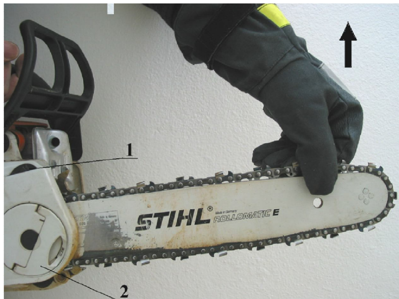
Prawidłowe napięcie łańcucha.
